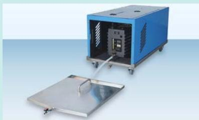
Das Sonation Ölwechselkit ersetzt den Ölblասstopfen der Pumpe mit einem komfortablen Ablassadapter mit Kugelhahn. Mit einem Handgriff lässt sich das komplette Öl in die mitgelieferte flache Ölauffangwanne komplett ablassen, ohne dass die Pumpe bewegt werden muss. Somit ist jeder Ölwechsel eine saubere und einfache Angelegenheit.
