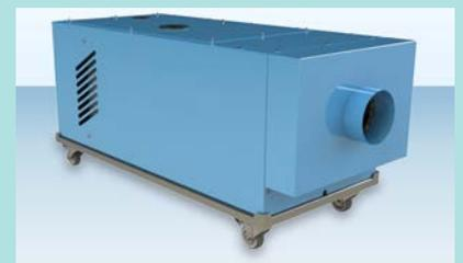
Dieses zusätzliche Gehäuse kann an der Rückseite der Schallschutzhaube montiert werden. Über einen 100mm Flansch kann nun die Abluft der Pumpe, und somit auch die Abwärme, der Laborabluft zugeführt werden. Sollte die Lüftungsanlage einmal ausfallen, dann wird die Abluft wieder in das Labor abgegeben, um ein Überhitzen der Pumpe zu verhindern.
